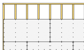
Figur 4.3c Horizontal montering. Montering av himlingsplater.
