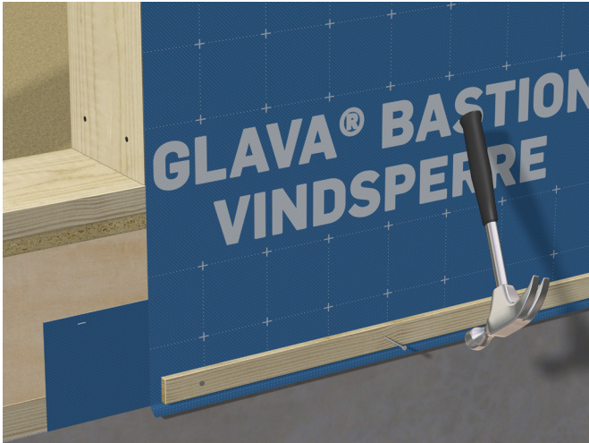
Fig. 36 Klemming av vindsperre mot grunnmursvill
