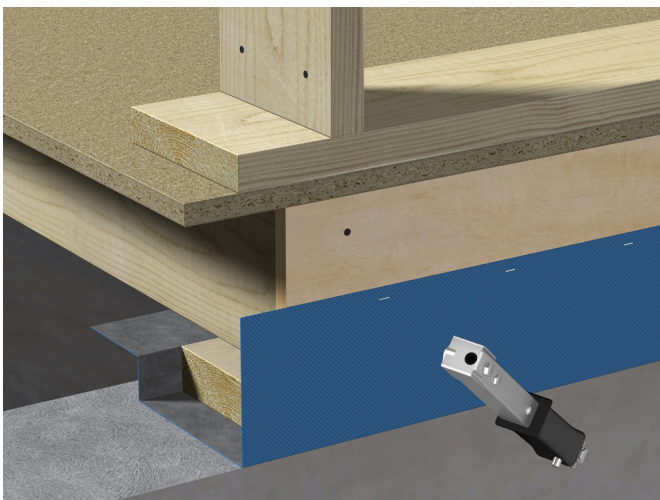
Fig. 24 Svillemembran med to lepper
