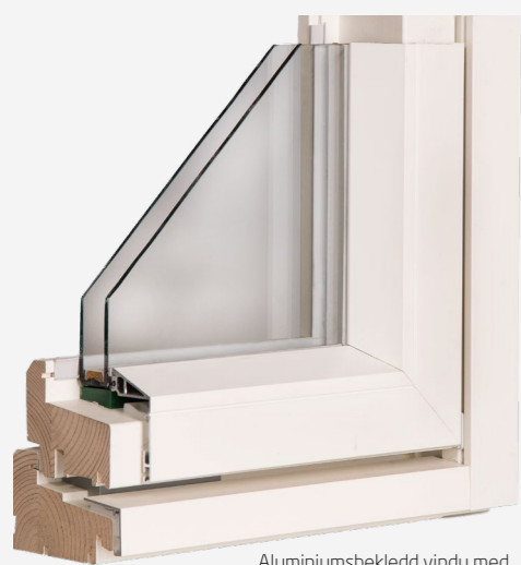
Aluminiumsbekledd vindu med 2-lagsglass og u-verdi 1,2
