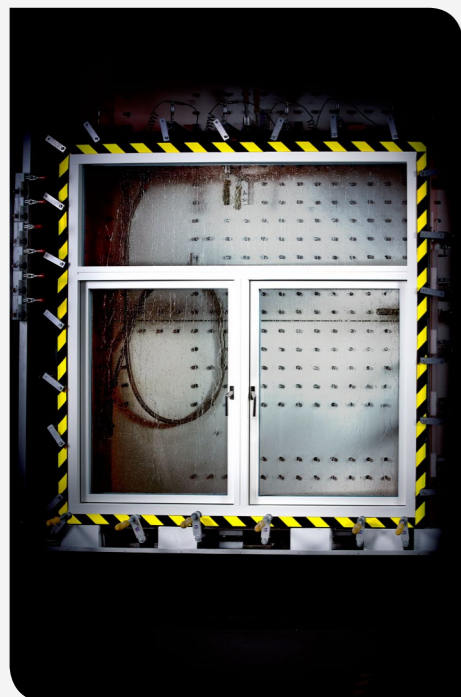
Natres skyvedører, terrassedører og vinduer testes mot orkan og innbruddstyver, blant annet.
