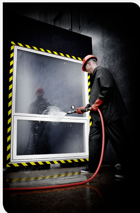
Natres skyvedører, terrassedører og vinduer testes mot orkan og innbruddstyver, blant annet.
